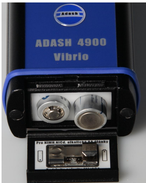
Fig. Colocando las baterías
